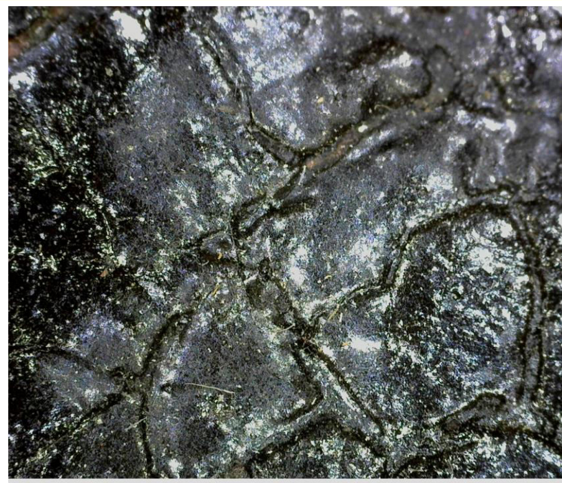
სურ. დეტალი. მიკროსკოპული ფოტო, 50 -იანი გადღებით. მიკრობზარები
