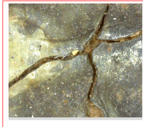
სურ. დეტალი. მიკროსკოპული ფოტო. მიკრობზარები.
