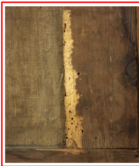
სურ. ხოჭოს საფრენი ხვრელები და მათ მიერ დაზიანებული დაზიანებული მერქანი.
